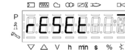
Интерфейс AZL может визуализировать также и код какого-либо случая, который не вызвал блокировку. Дисплей визуализирует текущий код с, чередуя его с кодом диагностики d:
