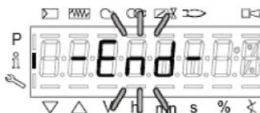
Нажать InFo на более чем три секунды или ESC для того, чтобы выйти из модальности InFo и вернуться на основной дисплей (Operate - работа)
