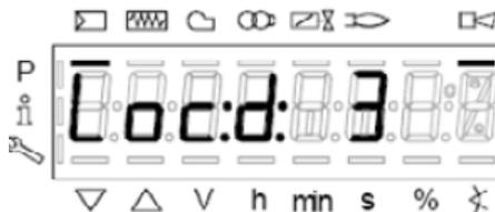
Код диагностики" (Diagnostic code): на примере "Код диагностики: 3". Зарегистрировать номера и проверить в таблице ошибок тип аварийного случая.
